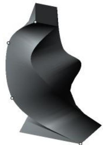
Элементы, образованные путем соединения разных точек одинаковых сечений
