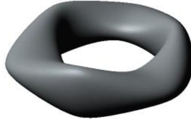
Разомкнутый и замкнутый элементы, построенные по одним и тем же сечениям
