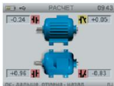
Рисунок 4.3 Значения параллельной и угловой несоосностей
