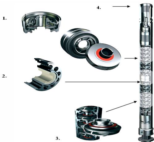
Рис.10 Верхняя секция ЭЦН (направляющие аппараты, радиальные и промежуточные подшипники, рабочие колеса)
