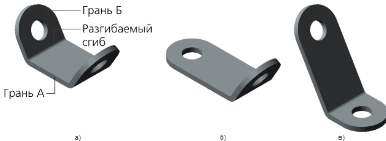
Зависимость результата разгибания от выбора плоскости разгибания а) исходное состояние детали, б) плоскость разгибания — грань А, в) плоскость разгибания — грань Б
